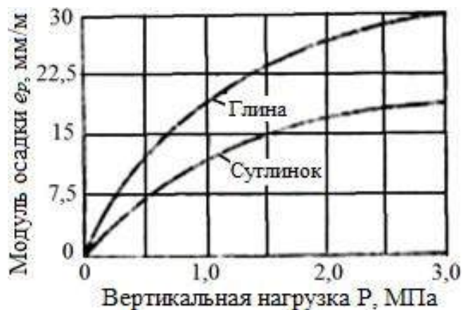
Рис. 7.8. Компрессионные характеристики грунтов
