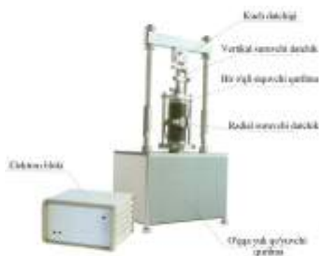
54-rasm. Gruntlarni bir o'qli siqish bilan sinovchi asbob.
